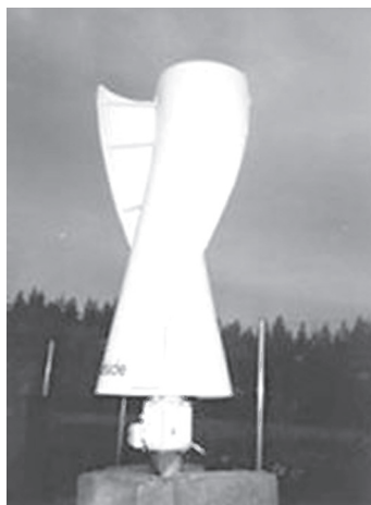
Рис.49. Роторные (карусельные) ветроэлектростанции вращаются вокруг вертикальной оси и работают при любом направлении ветра, они тихходные и малозумные
