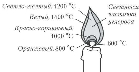
Рис.33. Схематическое изображение пламени свечи и распределение температур в различных точках пламени при горении в обычных условиях
