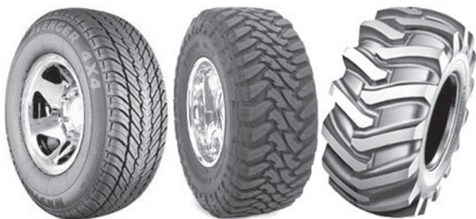
Рис.16. Покрышки автомобильных шин, предназначенные для летних дорог (слева), зимних дорог (в центре) и бездорожья (справа)
