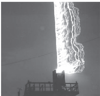
Рис. 103. Несколько разрядов молний, вызванных пуском ракеты в грозовую тучу. Самая левая вертикальная линия – след от запущенной ракеты
