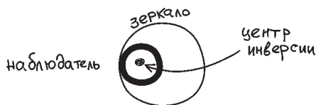
Рис.8. Отражение в цилиндрическом зеркале – инверсия в (жирной) окружности
