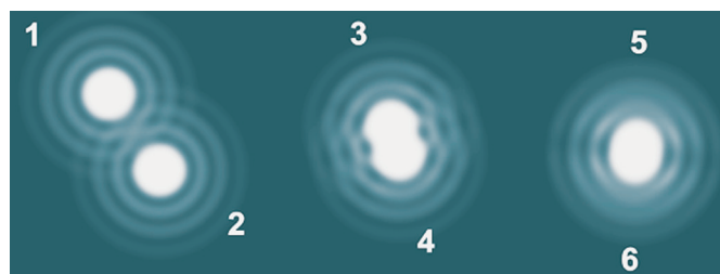
Рис.3. Изображения группы точечных источников. Источники 1 и 2 расположены на расстоянии, значительно большем d = \lambda / (n \sin u) , источники 3 и 4 – на расстоянии d/2 , а источники 5 и 6 – на расстоянии, значительно меньшем d/2
