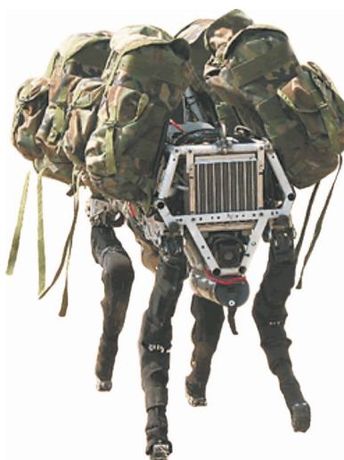
Рис.3. Навьюченный четырехногий робот «БигДог»
