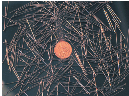
Рис.6. В качестве отражателей здесь использованы булавки
