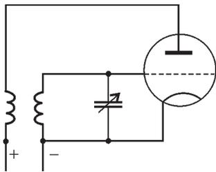
Запишем уравнение для собственных колебаний в колебательном контуре, состоящем из катушки индуктивности, конденсатора и резистора малого сопротив-
